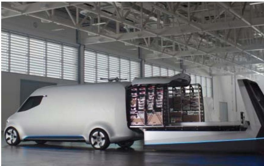
**A Vision Van dispõe de um compartimento de carga totalmente automatizado**
