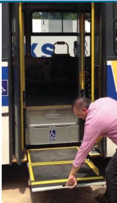
na posição de transporte, como escada de acesso. Com capacidade de carga de 250 quilos, a MKS 250 PDO pode ser instalada na lateral ou na parte de trás do veículo. O sistema eletro-hidráulico é
