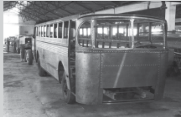
Em 1952, a Caio revolucionou a produção de carrocerias com a estrutura inteiramente metálica
