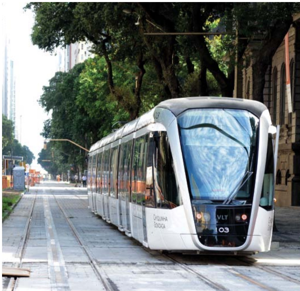
O VLT é alimentado pelo solo e dispensa o uso de fiação aérea (catenárias)
