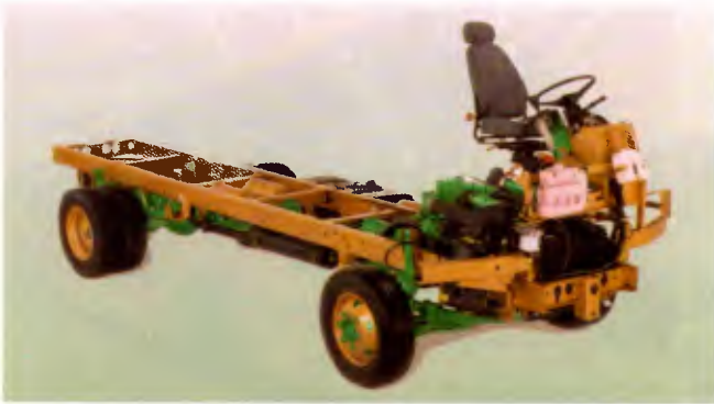
Agrale MA 8.5 Super, com motor de 160 cv e câmbio automático, tem baixo custo de manutenção
