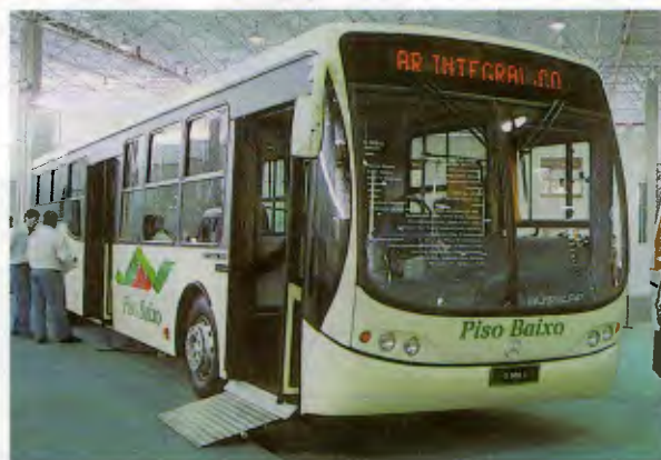
Mercedes-Benz O 500 U, de piso baixo, é equipado com motor eletrônico OM 906 LA, de seis cilindros
