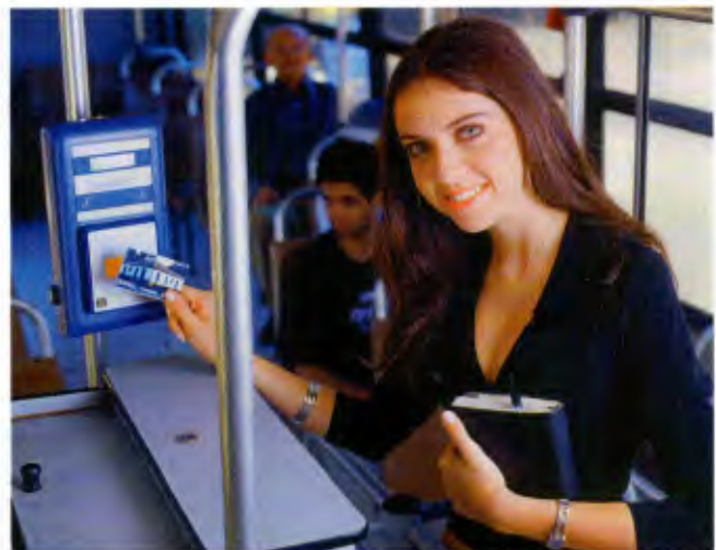
Os cartões, quando mostrados ao validador de alumínio, podem ser lidos até 10 cm de distância
