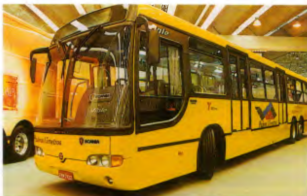
Scania L94UB 6x2, de 15 metros de comprimento, transporta 20% a mais de passageiros
