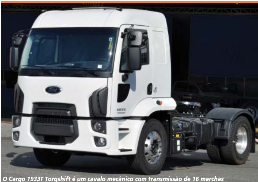
O Cargo 1933T Torqshift é um cavalo mecânico com transmissão de 16 marchas
