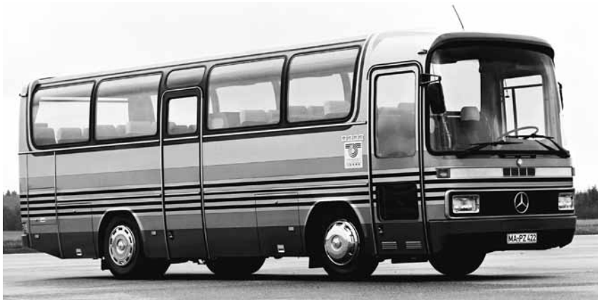
O 303, de 1974, foi pioneiro na fabricação modular com modelos para aplicações diversas
