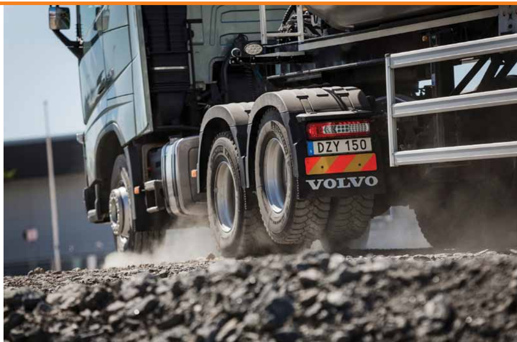
Caminhão FH 6x4 tem eixo suspensor, tecnologia que desengata e levanta o segundo eixo
