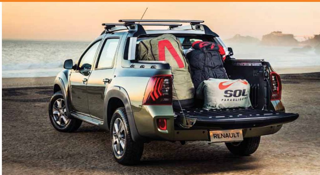
A caçamba comporta 683 litros de volume de carga e aguenta transportar até 650 quilos
