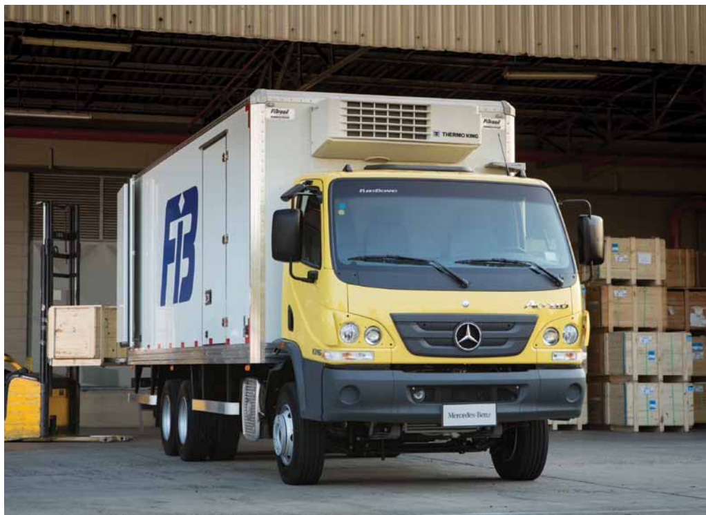
O novo Accelo 1316 6x2 de 13 t chega com terceiro eixo e suspensor originais de fábrica
