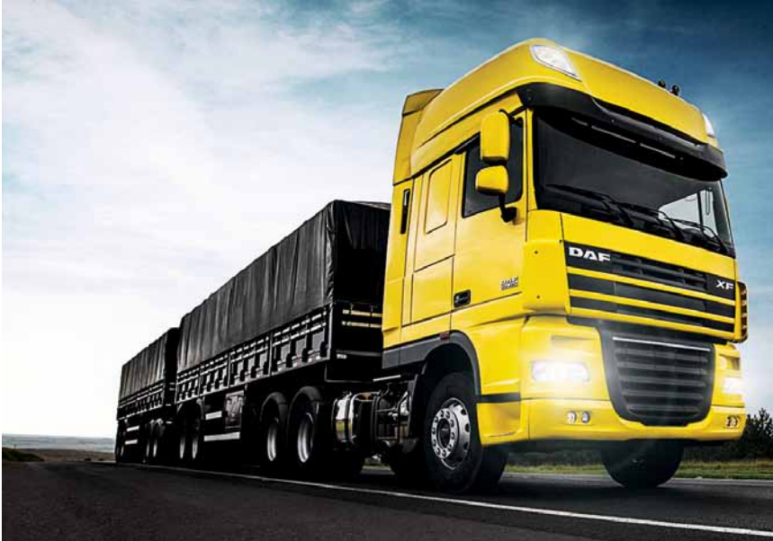
O extrapesado XF105 tem configurações 6x4 e 6x2, com potências de 410 cv, 460 cv e 510 cv
