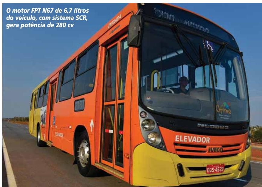
**O motor FPT N67 de 6,7 litros do veículo, com sistema SCR, gera potência de 280 cv**
