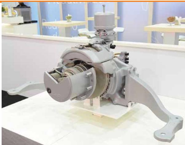
**O eixo elétrico AVE 130 da ZF pode ser utilizado para veículos de carga ou de passageiros**
