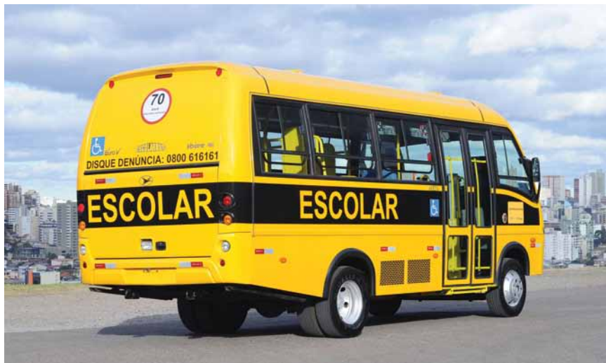
Escolarbus 4x4 tem eixo dianteiro tracionado e transmissão com opção de modos 4x2 e 4x4
