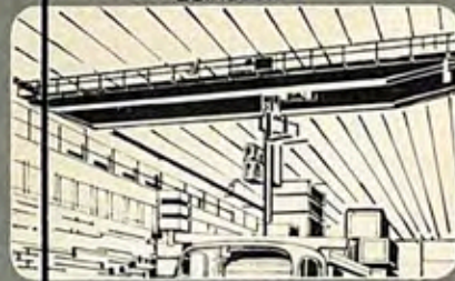
Ponte rolante empilhadeira
