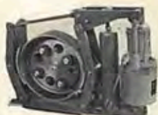
Freios tipo duas sapatas acionadas por Eldro ou pedal
