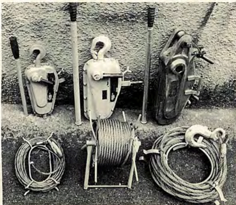
O aparelho é fabricado em três modelos, para capacidade de 750 a 3 000 kg.
