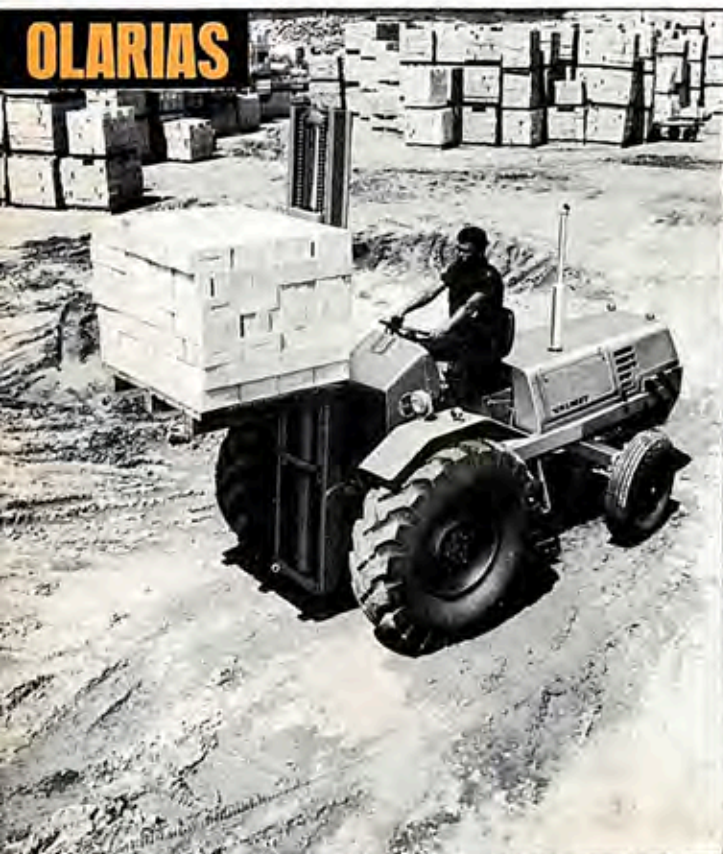
Um bom exemplo do desempenho da Empilhadeira Rotart Valmet: a carga, descarga, transporte e empilhamento de tijolos e cerâmicas nos terrenos sempre lamacentos das olarias e canteiros de obras civis: barragens, hidrelétricas etc.
