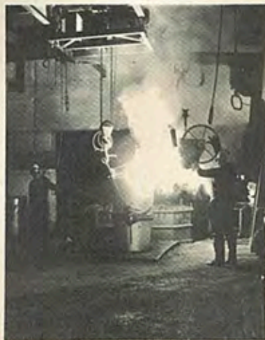
O ferro líquido é retirado dos fornos e despejado sobre as vagonetas.
