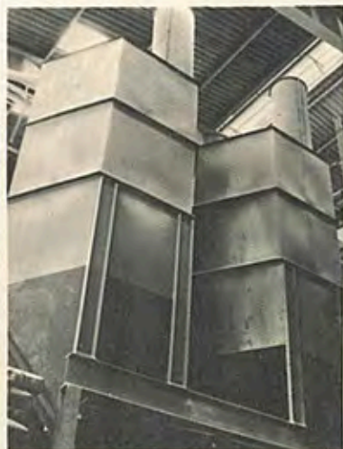
Silos de armazenagem que no novo sistema alimentam o misturador.
