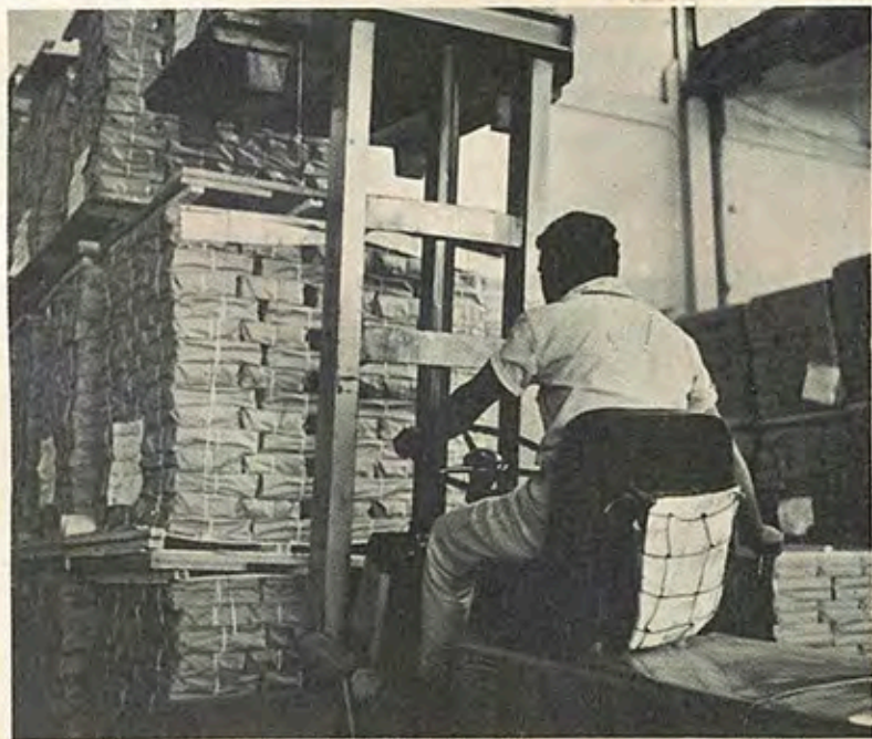
O uso de empilhadeiras permite melhor aproveitamento do pé-direito.
