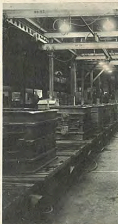
O mold reel tem 102 vagonetas que fazem o percurso total em 25 min.
