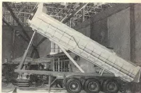
Com três eixos, leva até 25 m<sup>3</sup> de carga
