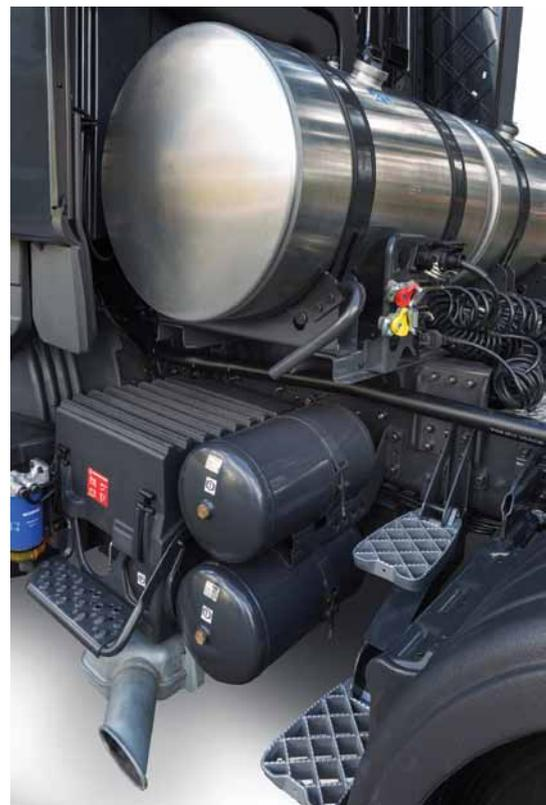
**Os tanques de combustível de 330 litros foram removidos das laterais, para dar espaço ao eixo, e fixados atrás da cabine**
