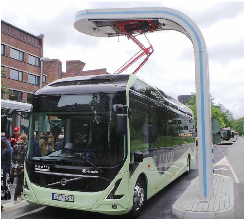
**Os ônibus elétricos Volvo, com 10,7 m de comprimento e capacidade para transportar 86 pessoas, usam baterias que são rapidamente recarregadas com eletricidade renovável nos dois extremos da linha 55 de Gotemburgo**
