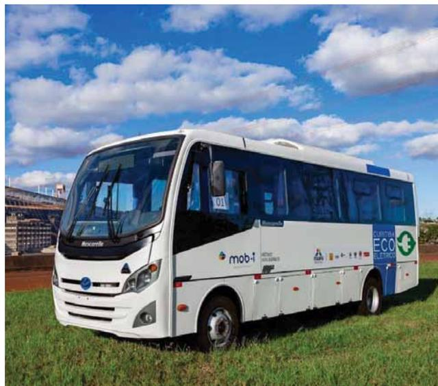
A Agrale, fabricante brasileira de chassis para micro-ônibus, desenvolveu um miniônibus elétrico em parceria com a Itaipu Binacional. Com carroceria Mascarello montada no chassi MA 8.7, este veículo passará a integrar a frota do projeto-piloto Curitiba Ecolétrico e será utilizado pela Guarda Municipal e pela Secretaria de Turismo.
