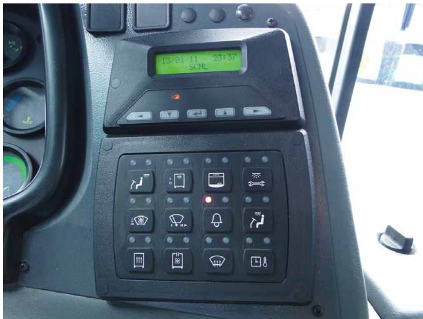
Novos itens embarcados incluem o Multiplex, que identifica falhas no sistema elétrico
