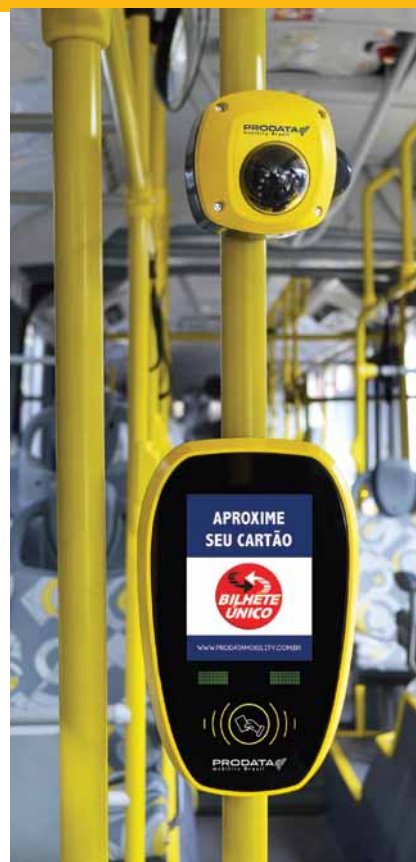
SPTrans homologou novos modelos de validadores, com capacidade de armazenar e transmitir dados e fotos via wi-fi
