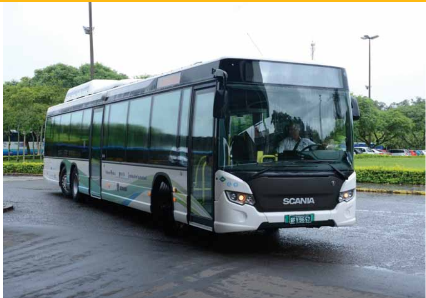
O ônibus movido a biometano em teste tem autonomia para percorrer 500 km por dia
