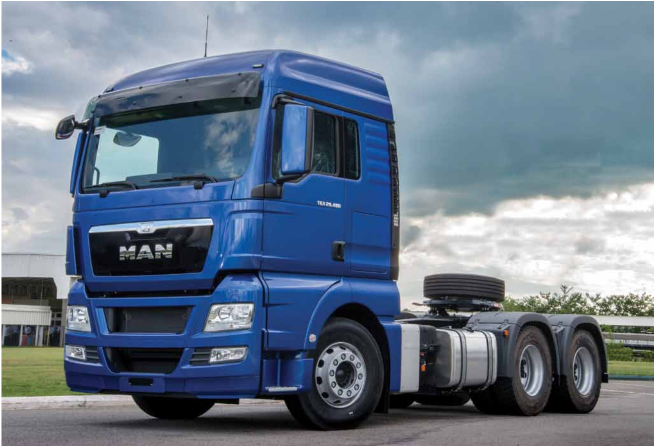
O novo extrapesado MAN TGX aplica-se a composições de grande peso, com cargas que variam de 57 a 74 toneladas
