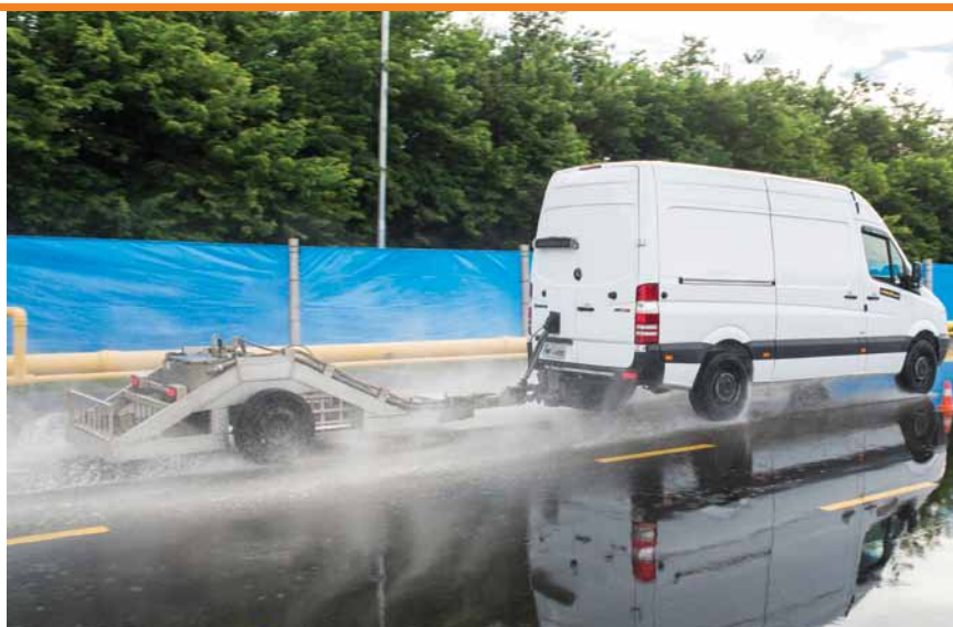
Engate tracionado por furgão simula carro em um teste de aderência de pneus
