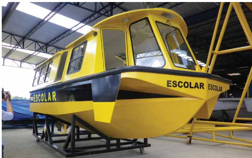
A nova lancha tem casco de aço, casaria em fibra de vidro e motor a diesel
