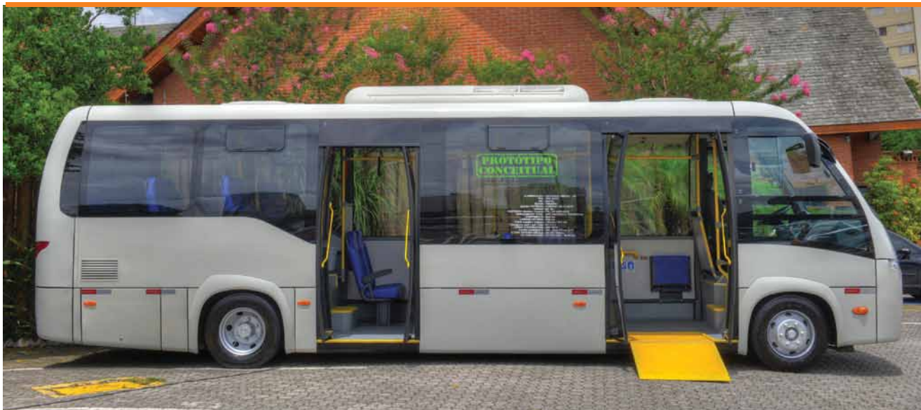
Volare Access: primeiro miniônibus da marca com piso baixo e motor traseiro com dimensões reduzidas
