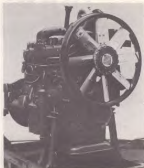
O ventilador de embreagem viscosa
