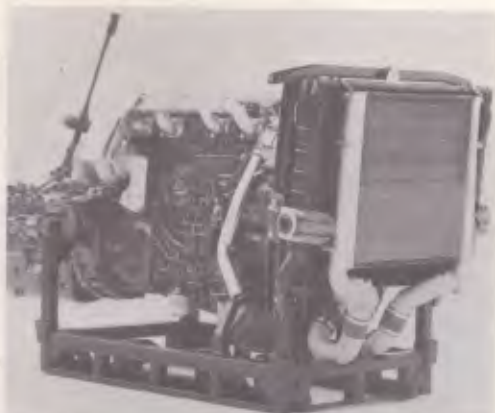
O intercooler, à frente do radiador
