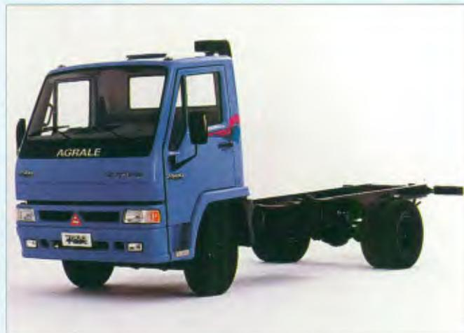
A Agrale substituiu os motores D 229 pela série 10 da MWM e o leve 7.500 ganhou mais potência, além de nova cabine
