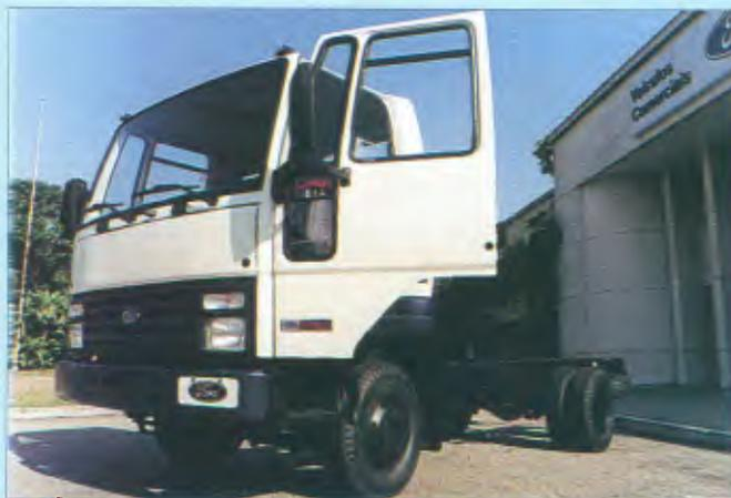
O Cargo 814 é o modelo mais recente da série e é o leve com o motor de maior potência, o Cummins B turbo intercooler com 140 cv
