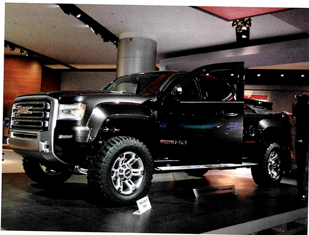
A grande picape GMC Sierra All Terrain tem motor de 6,6 litros, com potência de 397 cv
