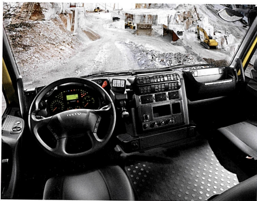
O painel é idêntico ao da linha Stralis e o volante tem regulagem pneumática
