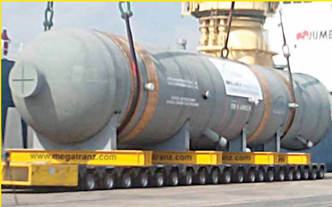
Projeto COMPERJ / Reator HCC / Peso 1022 ton
