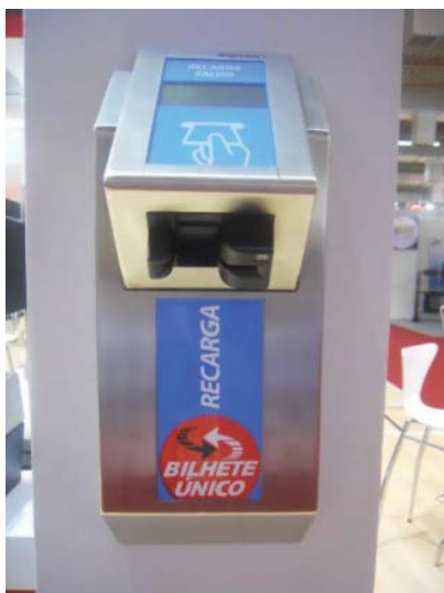
Terminal de recarga de créditos DG830 da Digicon, instalado na Linha 4 do Metrô-SP
