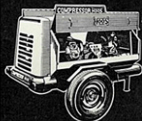
Compressor HOOS móvel, equipado com Motor Industrial VOLKSWAGEN
