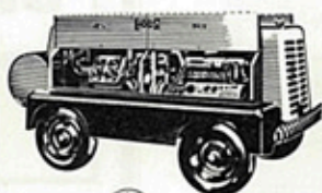
Compressor HOOS móvel com motor MERCEDES-BENZ
