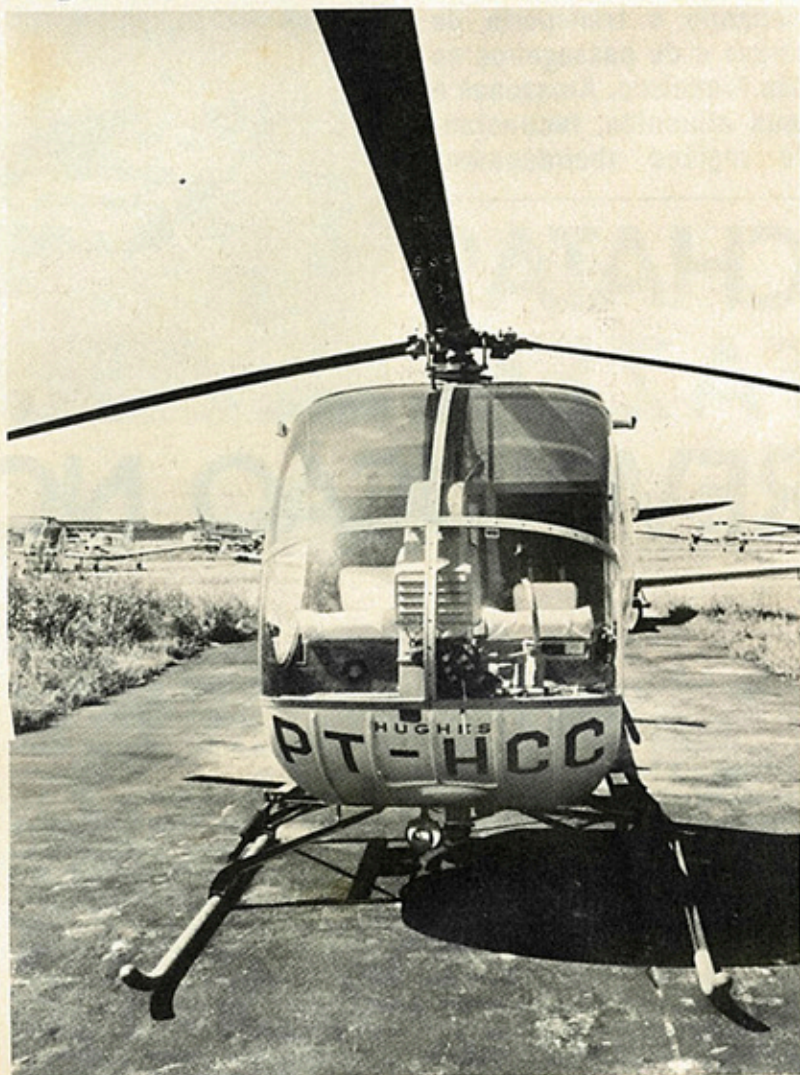
Hughes 300, para três pessoas, tem autonomia de voo de duas horas.
