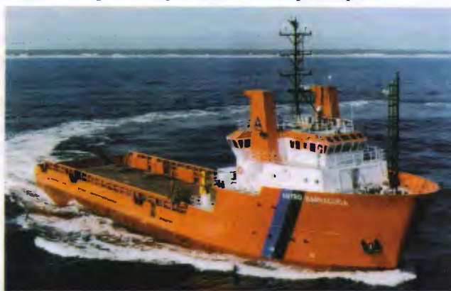
Embarcação Astro Barracuda, tipo PSV (platform supply vessel), de grande capacidade, transporta suprimentos
