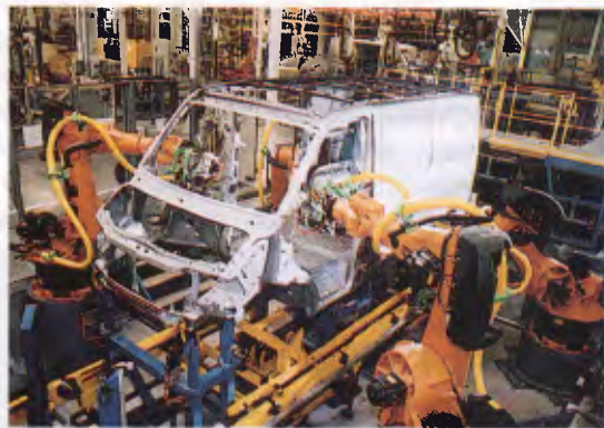
Robôs fazem a solda em 80 pontos da carroceria do Master
