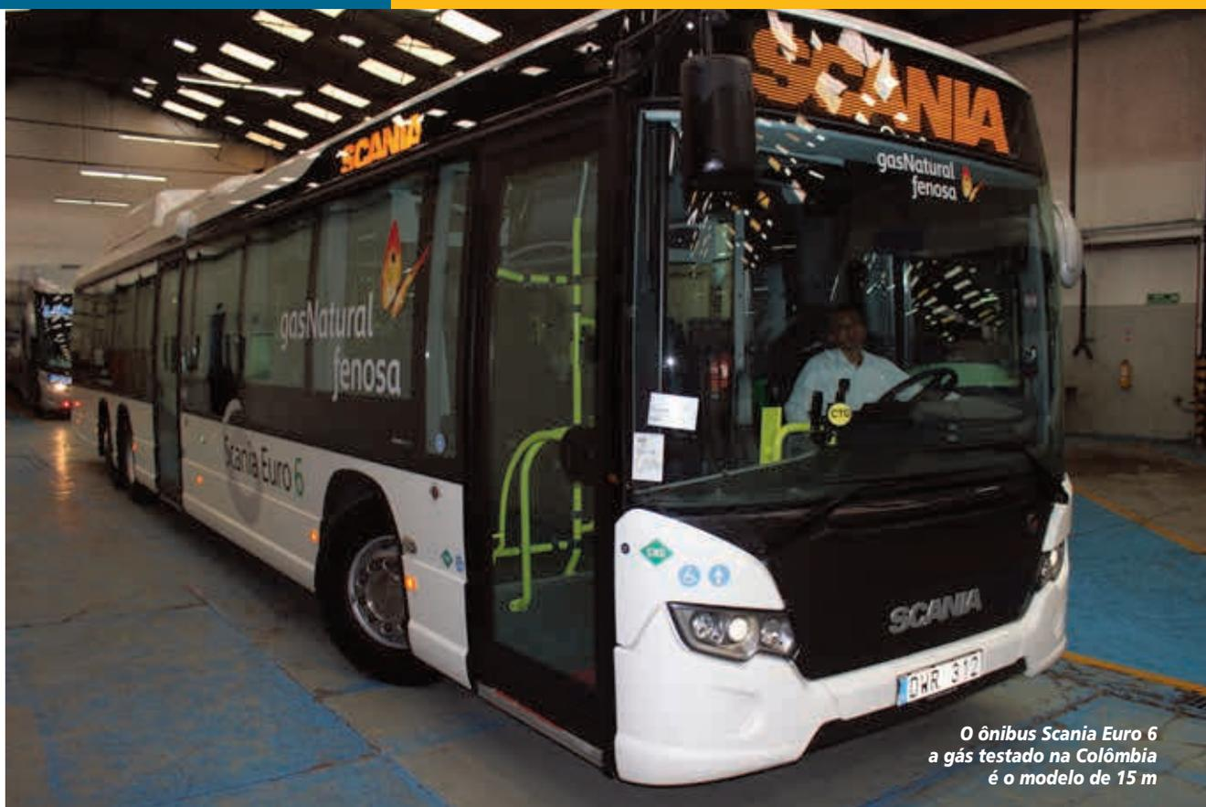
O ônibus Scania Euro 6 a gás testado na Colômbia é o modelo de 15 m
