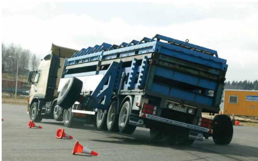
**Demonstração do sistema de segurança ESP antitombamento em pista de testes**
