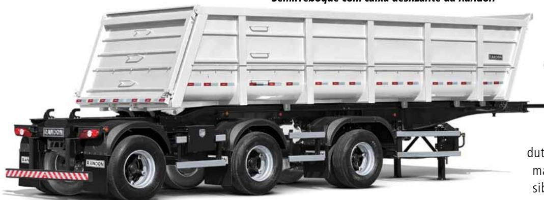
Geral Duralumínio, possui laterais fixadas por rebites. O produto conta com a instalação de protetores laterais aparafusados e fabricados em alumínio para redução da tara. A Carroceria Carga Seca-Graneleira Randon é produzida com componentes que atendem às leis e preceitos ambientais, e foi projetada para atender a demanda deste segmento, que é um dos mais representativos no segmento sobrechassi.
