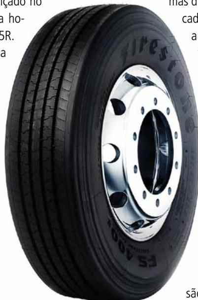
**FS400, pneu radial sem câmara da Bridgestone**
