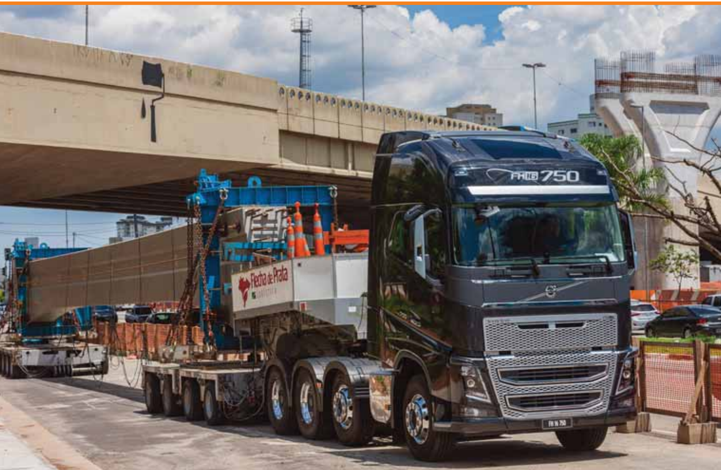
A Flecha de Prata testou o modelo FH 16 de 750 cavalos por um mês para transportar vigas nas obras do monotrilho de São Paulo
