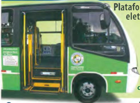
Plataforma elevatória eletro pneumática para ônibus
