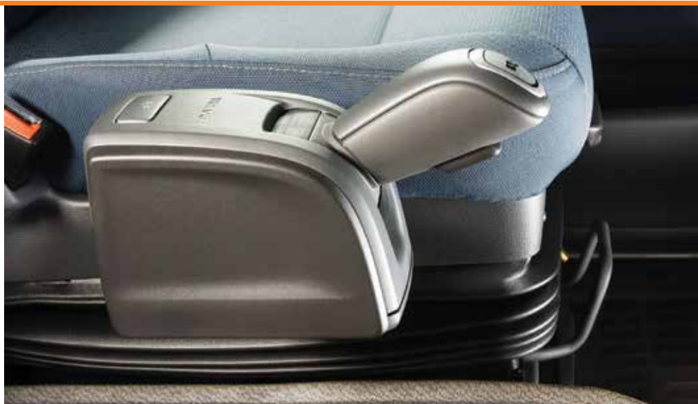
Para garantir o conforto do condutor, o seletor do modo de condução foi instalado numa área muito próxima, ao alcance da mão
