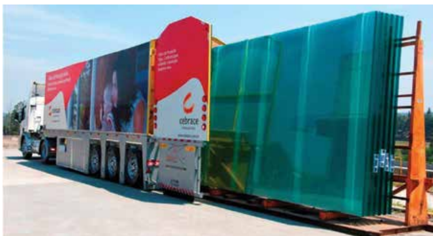
Carretas podem transportar lâminas de vidros de 6 m de comprimento e 4 m de altura
