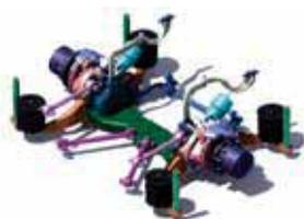
Eixo com motores embutidos nas rodas
