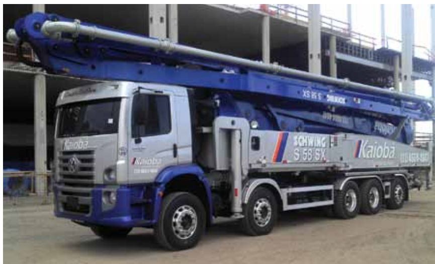
A primeira unidade do VW 31.390 10x4 foi implementada com lança de concreto de 57,3 m
