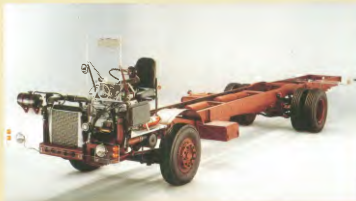
Chassi-modelo/Chasi-modelo/Chassi model: OF-1620 Motor-potência/Motor-potencia/Engine power: OM 366 LA/200 cv Peso do chassi/Peso del chasi/Chassi weight: 4,68 t Entre-eixos/Distancia entre los ejes/Wheelbase: 6,05 m
