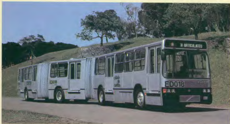
Carroceria/Carrocería/Body: Biarticulado Aplicação/Aplicación/Use: Urbana/Úrbana/Urban Estrutura/Estructura/Structure: Aço galvanizado/Acero galvanizado/Galvanised steel Largura/Ancho/Width: 2,50 m Comprimento/Largo/Length: 24,50 m Chassis que podem ser encarroçados/Chasis que pueden ser ensamblados/Embodiment-feasible chassis: Volvo
