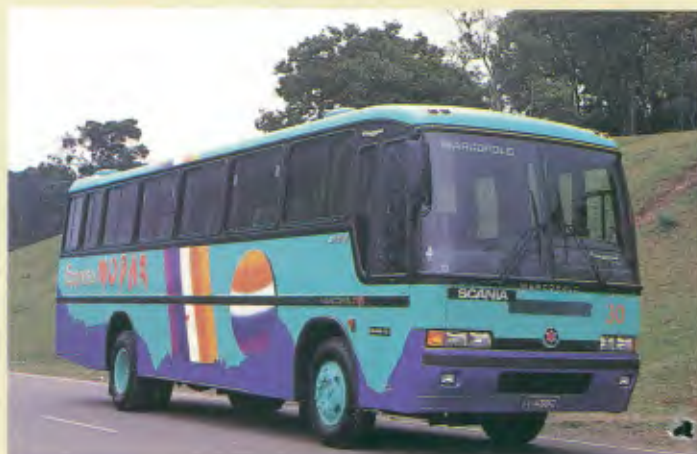
Carroceria/Carrocería/Body: Viaggio GV 850 Aplicação/Aplicación/Use: Rodoviária/Para carretera/Coach Estrutura/Estructura/Structure: Aço galvanizado/Acero galvanizado/Galvanised steel Largura/Ancho/Width: 2,60 m Comprimento/Largo/Length: até 12,00 m Chassis que podem ser encarroçados/Chasis que pueden ser ensamblados/Embodiment-feasible chassis: Scania, Volvo, Mercedes-Benz, Ford e Volkswagen
