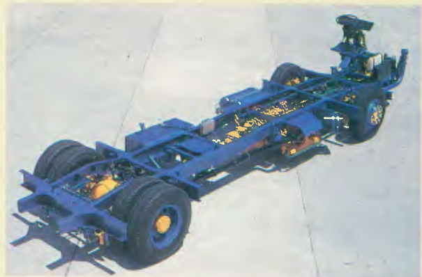
Chassi-modelo/ Chasi-modelo /Chassi model: B58 Urbano Motor-potência/ Motor-potencia /Engine power: THD 101 GC/250 cv. Entre-eixos/ Distancia entre los ejes / Wheelbase:6,00m
