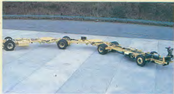
Chassi-modelo/ Chasi-modelo /Chassi model: B58 Urbano Motor-potência/ Motor-potencia /Engine power: THD 101 GC/250 cv. Entre-eixos/ Distancia entre los ejes / Wheelbase:6,00m
