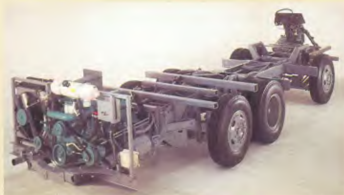
Chassi-modelo/Chasi-modelo/Chassi model: K 113 TL Motor-potência/Motor-potencia/Engine power: DS 1175/360 cv Peso do chassi/Peso del chasi/Chassi weight: 6,83 t Entre-eixos/Distancia entre los ejes/Wheelbase: 5 m até/ hasta/up to 7,60 m
