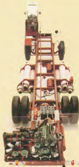
Chassi-modelo/Chasi-modelo/Chassi model: OH-1315 a gás Motor-potência/Motor-potencia/Engine power: M-366 G / 150 cv Peso do chassi/Peso del chasi/Chassi weight: 4,82 t Entre-eixos/Distancia entre los ejes/Wheelbase: 5,17 / 5,55/6,05 m
