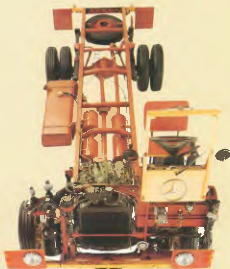
Chassi-modelo/Chasi-modelo/Chassi model: OF-812 Motor-potência/Motor-potencia/Engine power: OM 364 A/122 cv Peso do chassi/Peso del chasi/Chassi weight: 2,55 t Entre-eixos/Distancia entre los ejes/Wheelbase: 4,25 m
