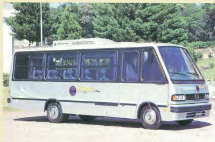
Carroceria/Carrocería/Body: Senior Aplicação/Aplicación/Use: Diversas/Diversas/Various Estrutura/Estructura/Structure: Aço galvanizado/Acero galvanizado/Galvanised steel Largura/Ancho/Width: 2,24 m Comprimento/Largo/Length: 7,68 m Chassis que podem ser encarroçados/Chasis que pueden ser ensamblados/ Embodiment-feasible chassis: Mercedes-Benz, Volkswagen, Ford e Agrale
