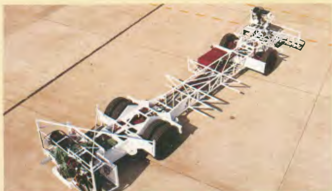
Plataforma-modelo/Plataforma-modelo/Frame model: O400 UP Motor-potência/Motor-potencia/Engine power: OM449 A (turboalimentado)/ 245cv Entre-eixos/Distancia entre los ejes/Wheelbase: 6,33m
