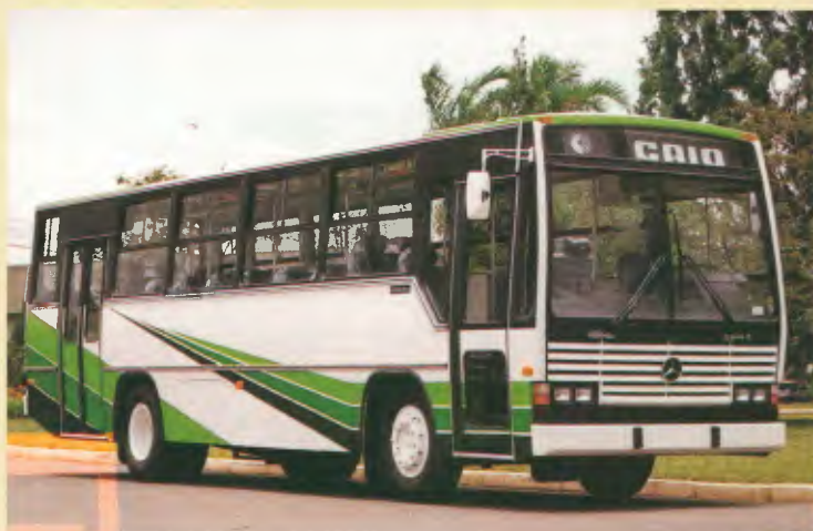
Carroceria/Carrocería/Body: Vitória Aplicação/ Aplicación/Use: Urbana/ Urbana/Urban Estrutura/Estructura /Structure: Chapa estampada Largura/Ancho/Width: 2,60 m Comprimento/Largo/Length: 11,02m Chassis que podem ser encarroçados/Chasis que pueden ser ensamblados/ Embodiment-feasible chassis: Mercedes-Benz, Volkswagen, Ford
