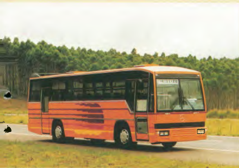
Carroceria/Carrocería/Body: Vitória Aplicação/ Aplicación/ Use: Urbana - Interurbano - Rodoviária/ Urbana - Interurbano - Para carretera / Urban - Intercity - Coach bus Estrutura/Estructura/Structure: Aço e alumínio/ Acero e aluminio/ Steel and aluminum Largura/Ancho/Width: 2,60 m Comprimento/Largo/Length: 10,988 m Chassis que podem ser encarroçados/Chasis que pueden ser ensamblados/ Embodiment-feasible chassis: Mercedes-Benz, Volkswagen, Ford e Mafersa
