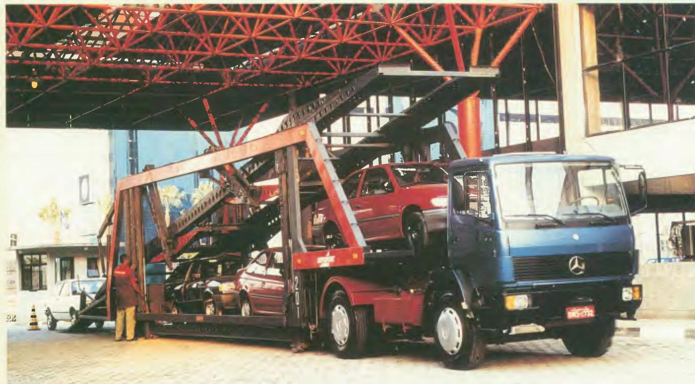
1721S: o pesado que possibilita engate ce semi-reboque de 15,70 m graças ao entre-eixo de 3,20 m e menor balanço dianteiro (ver pág. 33)
