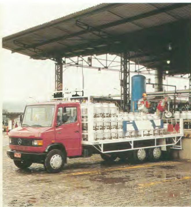
1114: o leve da Mercedes-Benz que transporta a carga do médio graças ao terceiro-eixo de rodagem simples (ver pág. 33)
