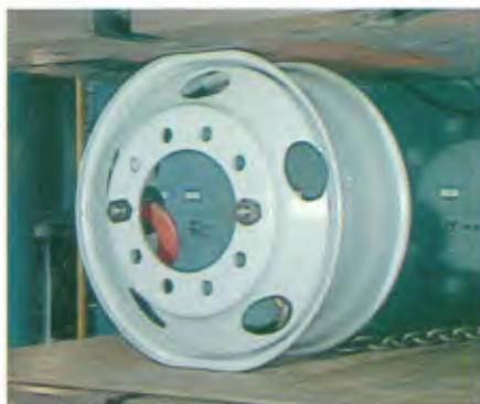
Roda disco de aço soldada resiste uma carga de 13.6 t quando ocorre a deformação de 5 cm.
