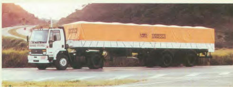
C-4030: o modelo mais pesado da linha Cargo traciona semi-reboque de dois eixos distanciados e 40 t de PBTC (ver pág. 34)
