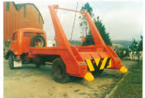
Poliguindaste Sistema de multi caçambas próprio para utilização em minas, pedreiras, e coleta de lixo. Dotado de pistões hidráulicos de alta ou baixa pressão, filtro de óleo e válvulas de controle de pressão e vazão.
