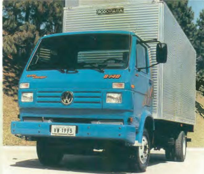
8-140: o leve mais potente da VW, tem motor MWM-4.10 turbo de 135 cv e oferece duas opções de entre-eixos e carroceria de até 5,50 m (ver págs. 34 e 36)
