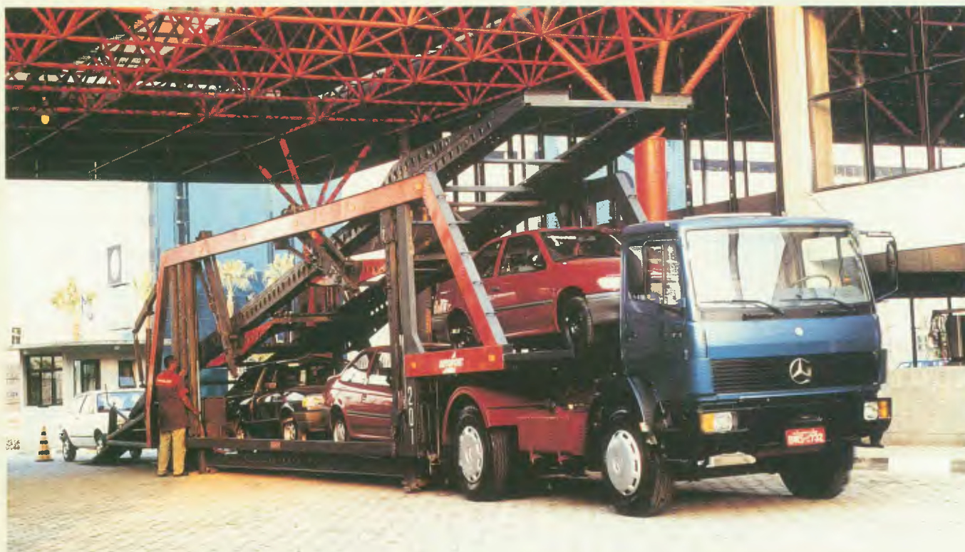
1721S: o pesado que possibilita engate de semi-reboque de 15,70 m graças ao entre-eixo de 3,20 m e menor balanço dianteiro (ver pág. 33)
