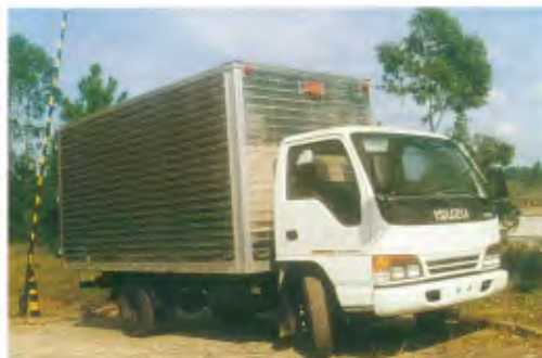
Baú Especialmente projetado para cada tipo de trabalho, com portas em quantidade e dimensões solicitadas. Estrutura de aço ou alumínio, revestimento externo em chapa de alumínio, isotérmico ou frigorífico.
