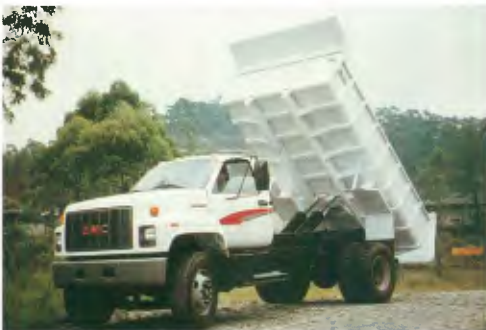
Basculante Construída em chapa de aço, tendo sua caixa de carga com cantos arredondados ou chanfrados e reforços estruturais externos que proporcionam grande rigidez ao conjunto. Sistema hidráulico de baixa ou alta pressão.
