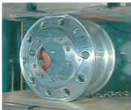
Roda Forjada de Alumínio Alcoa resiste a uma carga de 71.2 t quando ocorre 5 cm de deformação.
