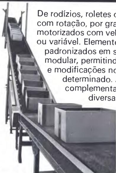
De rodízios, roletes ou correias com rotação, por gravidade ou motorizados com velocidade fixa ou variável. Elementos padronizados em sistema modular, permitindo ampliações e modificações no trajeto determinado. Acessórios complementares e diversas capacidades proporcionam a instalação ideal. Consultem nosso Depto. Técnico.
