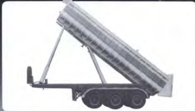
Na foto, semi-reboque basculante especial para transporte de areia e brita.
