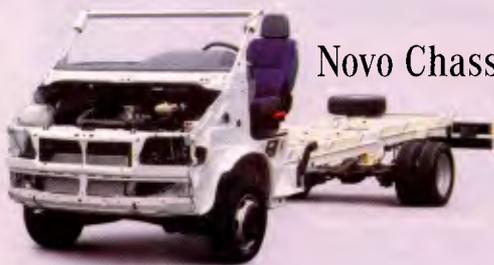
Novo Chassi 412 D Windlauf para minibus Mercedes-Benz.
