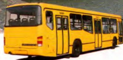
Viale Low Entry tem o piso rebaixado para facilitar o embarque e desembarque. As portas de acesso e as janelas foram ampliadas e a qualidade de acabamento interno se destaca. Tão confortável que os passageiros vão fazer questão de ir com ele.
