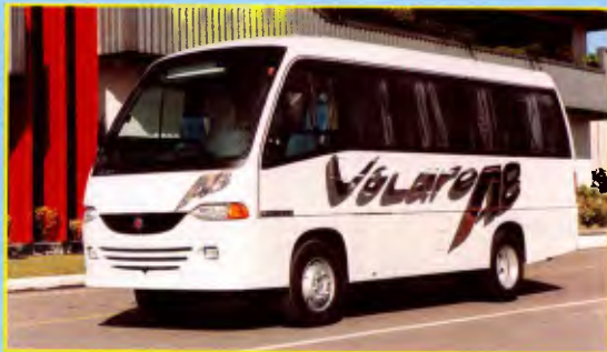
Volare A-8, da Marcopolo: motor MWM 4.10 TCA Turbo Aftercooler atende norma Euro II
