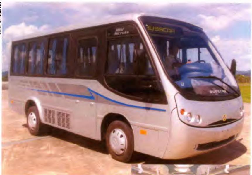
O Mini Micruss VW 8.140 CO, com carroceria Busscar, pode transportar até 20 pessoas sentadas, incluindo o motorista e o auxiliar
