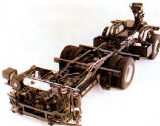
Chassi L94 com motor traseiro pode ter Scania Retarder e oferece mais espaço para ar condicionado
