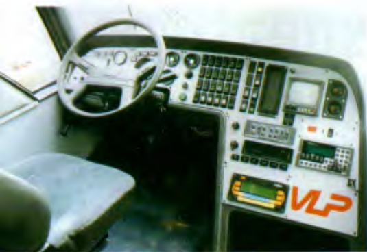
Painel de instrumentos com vídeo que monitora interior do veículo
