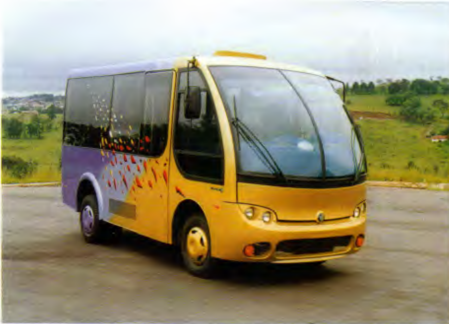
O Piccolino tem 1,90 m de altura interna e transporta até 24 passageiros
