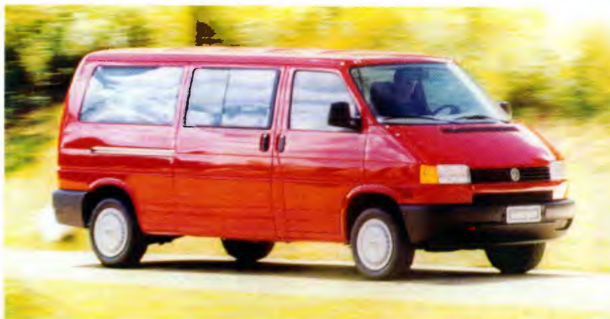
Eurovan, com motor diesel 2.4 serve ao transporte de até 11 passageiros
