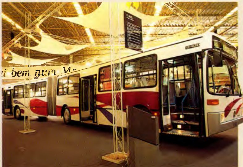
O 400 UPA da Mercedes: articulado com motor traseiro da série 449 de 300 cv
