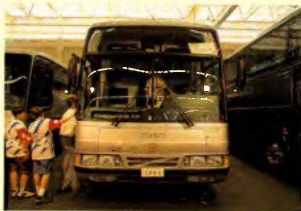
No Gallegiante reestilizado, teto com laterais arredondadas; na versão 3.60, maior visão para os quatro passageiros da frente
