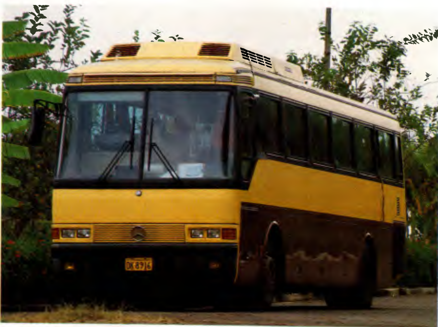
Sistema de ar condicionado instalado no teto melhora a estética
