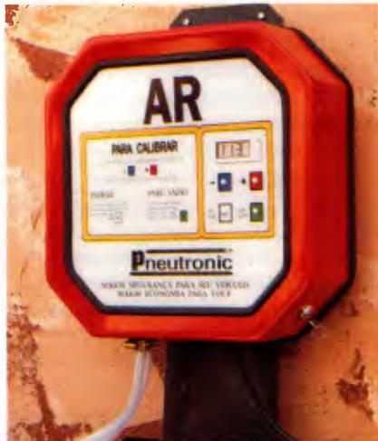
so de uma frota homogênea, não precisar se deslocar até o aparelho para confirmar a calibragem, pois o aparelho dá uma alarme sonoro quando a pressão se igualou à requerida e mantém os dados para calibrações subsequentes.
