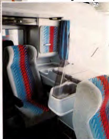
Existem várias versões de bares modulares em fibra de vidro com geladeira elétrica ou conservadora de frio, além de forno microondas, cafeteira elétrica ou térmica.
