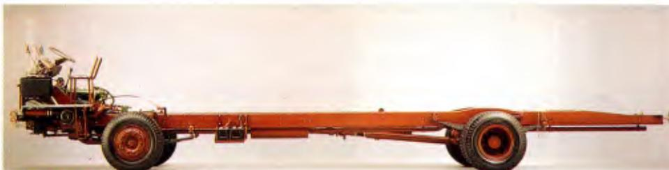
No OF-1618 as longarinas mantêm espessura até a metade do balanço traseiro. Reforçado
