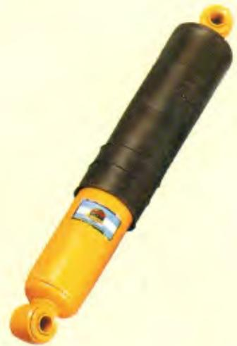
Graças à sua alta performance, os amortecedores Delfabro são especialmente indicados para ônibus dotados de suspensão a ar, onde também assumem a função de segurar a carroceria, eliminando o efeito "gôndola", responsável pelo balanço lateral do veículo. Mário Cuono garante a total estabilidade dos ônibus. A Delfabro pretende aumentar sua produção de 90 mil unidades/mês para 160 mil unidades/mês em 1993.
