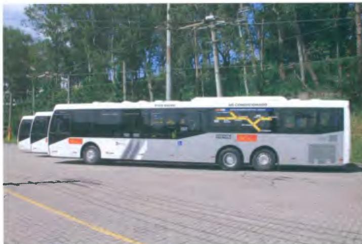
Os ônibus Scania de 15 m têm 3 eixos, piso baixo e sistema de ajoelamento
