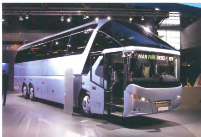
Ônibus Neoplan encarroçado com chassi MAN que tem nova tecnologia EEV para uso de diesel limpo
