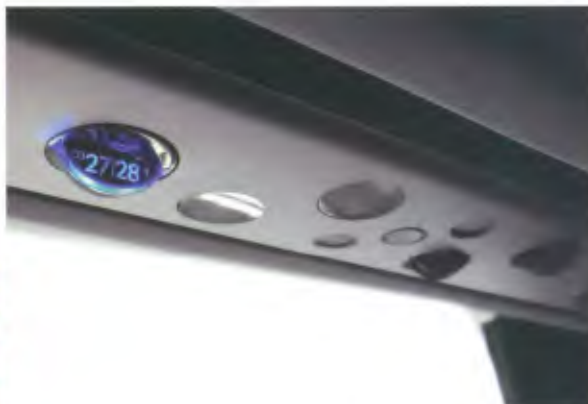
Luz halógena no teto, luz interior fluorescente e sistema de climatização independente para motorista e passageiros estão entre os itens básicos do modelo que chega agora ao mercado
