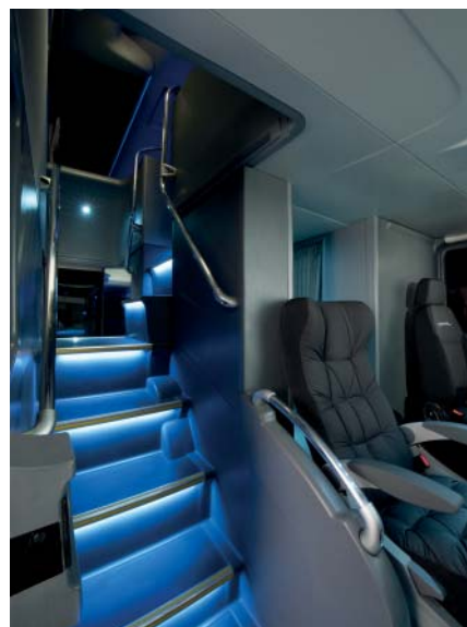
Escada foi projetada com iluminação indireta integrada aos degraus
