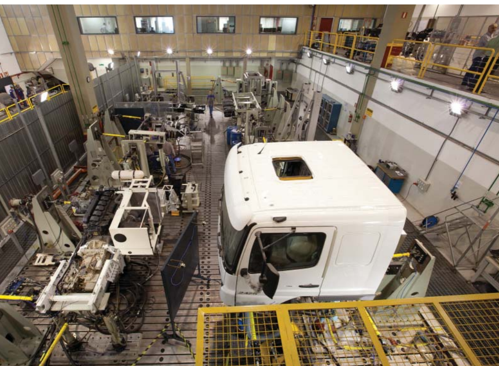
Testes de componentes são feitos com recursos do sofisticado banco de testes Hydropuls
