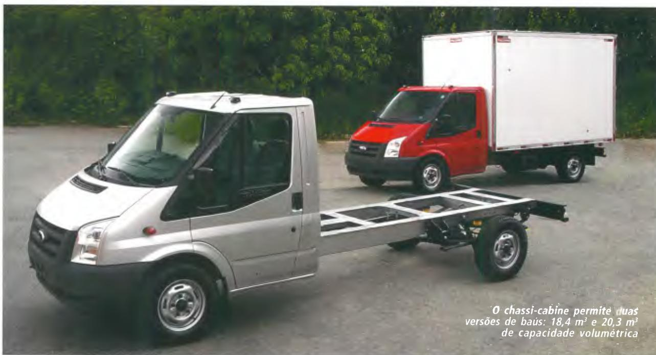
*O chassi-cabine permite duas versões de baús: 18,4 m<sup>3</sup> e 20,3 m<sup>3</sup> de capacidade volumétrica*
