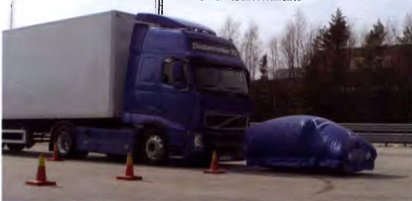
Control Cruise Active: sistema que mantém a distância entre o caminhão e o carro à frente está em fase de desenvolvimento
