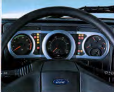
Painel com piloto automático* e diagnóstico de falhas
