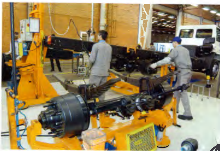
Instalação de terceiro-eixo é uma das modificações mais comuns
