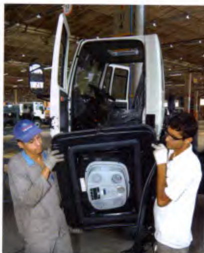
Colocação de resfriador da cabine, serviço disponível no Mod Center
