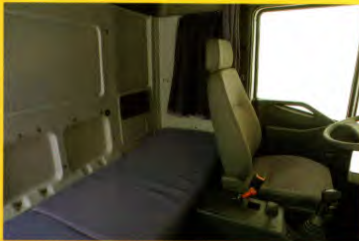
A cabine leito, com bancos e coluna de direção ajustáveis
