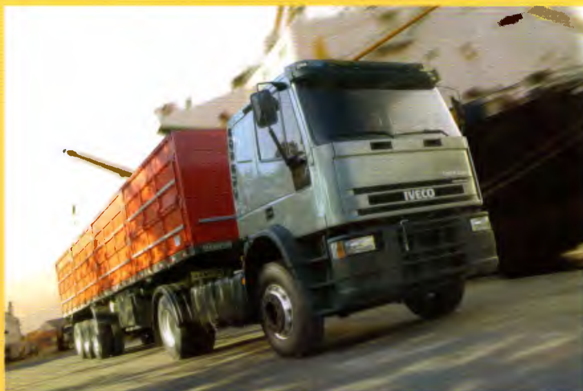
O Cavallino é o primeiro EuroCargo a receber o motor Cursor 8, de 7,8 litros e 320 cv de potência, desenvolvido para o mercado sul-americano
