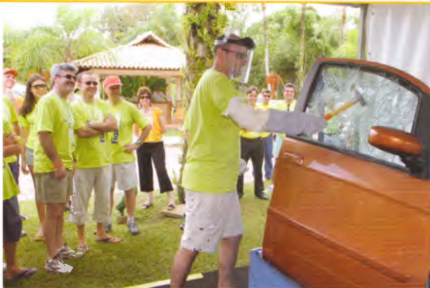
Testes demonstram que rompimento parcial do vidro laminado só ocorre após vários golpes com o martelo
