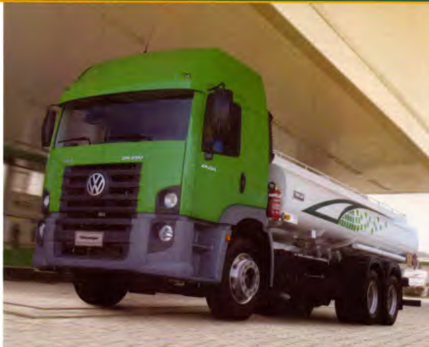
VW 24.250 é equipado com o motor eletrônico Cummins Interact de 6 cilindros e 250 cv
