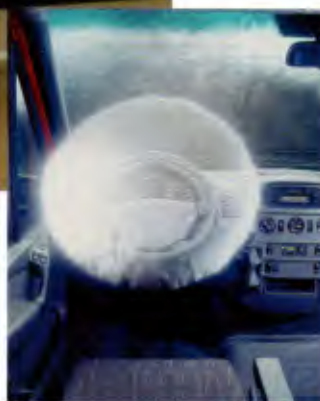
A van, em duas versões, é equipada com airbag para motorista
