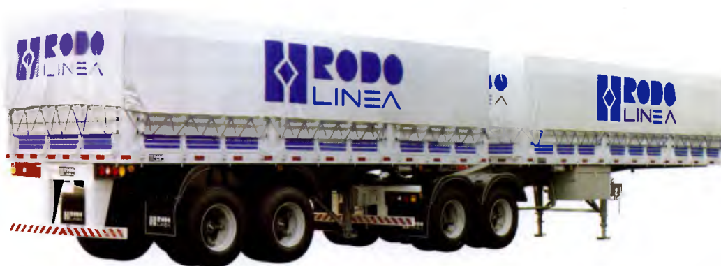
Bitrem graneleiro Rodo Linea: 18 m de comprimento e 37,5 t de capacidade de carga
