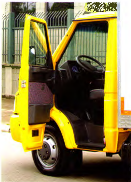
Motor fora do habitáculo reduz nível de ruído e de calor
